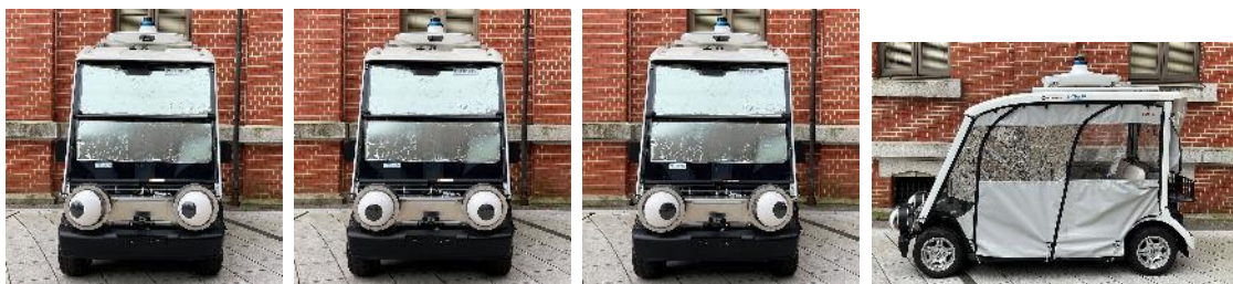
図 1: 視線提示できる目を付与した自動運転車の実験車両。
