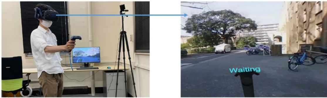
図 2: バーチャルリアリティー技術を利用した被験者実験の様子。図右は実験参加者がバーチャルリアリティー上で見ている画像。画像奥から向かってくる車両を見て、実験参加者（歩行者）が道路を渡るかどうかを判断する。
