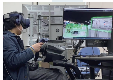
VR機器とデジタルツインによる運転支援UI Driving support UI using VR equipment and digital twin
