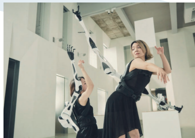
着脱式ロボットアームからなるウェアラブルシステム「自在肢」
