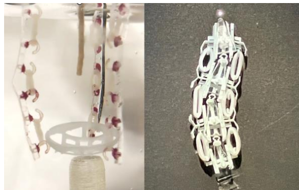
筋肉のリングで動く多関節グリップ（左）、ヘビ型ロボット（右）
