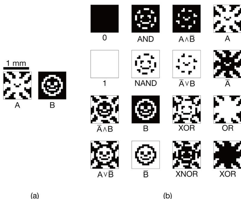
図 1 : Diffraction Casting を用いた演算結果の例
