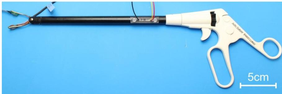
図 1. 先端把持部に MEMS 6 軸力センサを実装した内視鏡手術用把持鉗子
