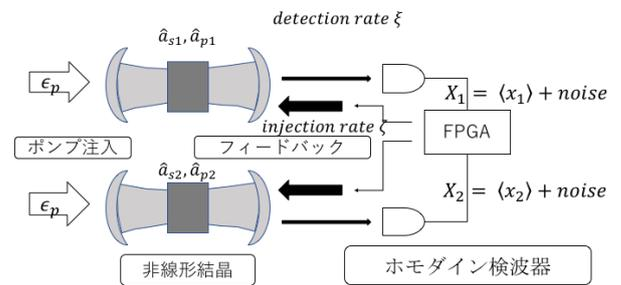
図 1. 測定フィードバック型 CIM の理論モデル (N=2)
