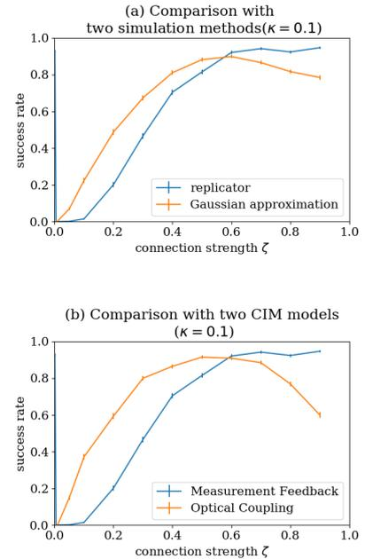
図 3.  $N = 16$  反強磁性体一次元リングにおける、CIM モデルの性能比較。(a) が量子モデルとガウス近似モデル、(b) が光結合型と測定フィードバック型の比較である。
