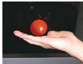
さわられる空中映像。超音波で触覚を誘起することにより、空中映像に触感を付加する
