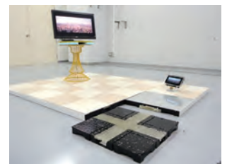
二次元通信タイル：タイル状の二次元通信シートを接続していくことで、床全面に高速通信環境を実現
