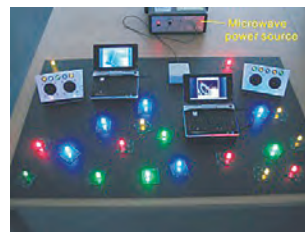
面に沿って伝播する電磁波で信号と電力をワイヤレス伝送する
