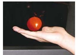
さわれる空中映像。超音波で触覚を誘起することにより、空中映像に触感を付加する
