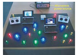
面に沿って伝播する電磁波で信号と電力をワイヤレス伝送する
