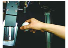
物体を把持する手の硬さを非接触で計測し、把持力を推定
