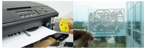
図1 インクジェットプリンタとインクジェット印刷で製作したプリント基板
