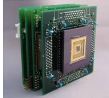
図 4: 開発したビジョンチップシステム
