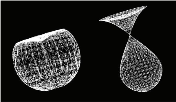
図 2: 左は細分割の双対構造によって作られたメッシュで非凸で変曲点を有している．右は通常の細分割で作られた対応するメッシュで変曲点の双対として嘴点を持っている．
