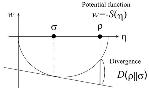
図 1: フォンノイマンエントロピーと量子ダイバージェンスとの幾何学的構造。  $\eta$  はここでは 3 次元を表す。
