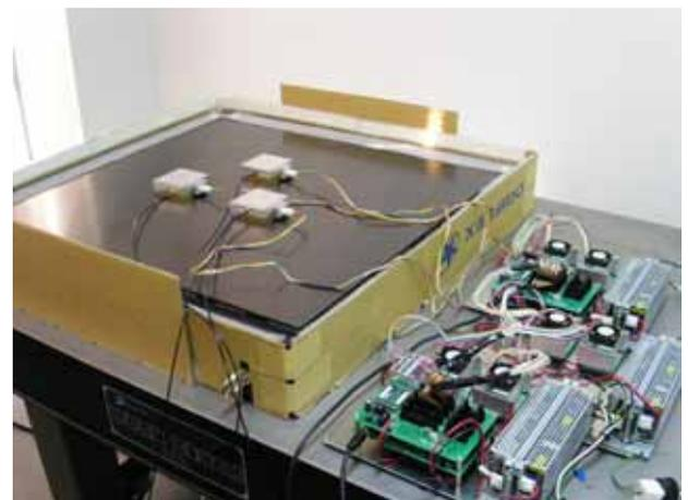
図2 平面リニアモータシステム
