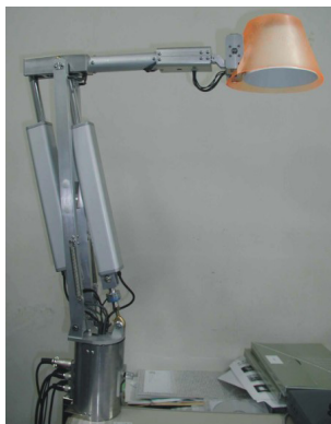
Fig.1 ロボティック照明 (能動的照明装置)
