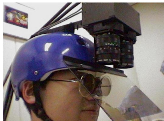
図4 HMP model-2 プロジェクタ部
