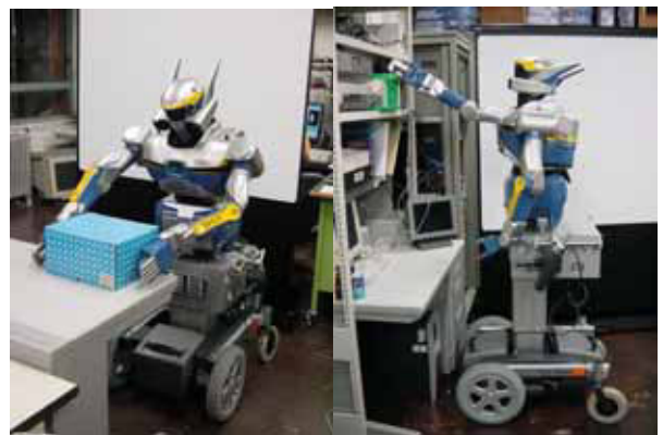
図4 (左)スライド機構が一番低い位置の状態 (右)スライド機構が一倍高い位置の状態
