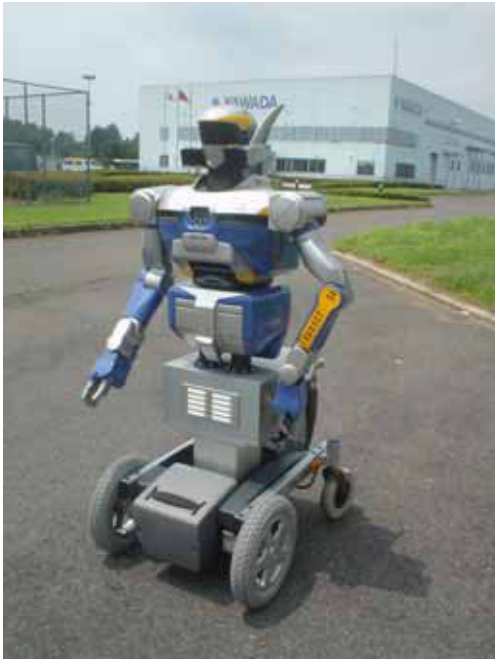
図2 ヒューマノイドロボットプラットフォーム HRP-2W
