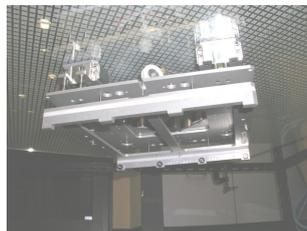
リンクアップユニットはアクチュエーションユニットとの"連結機能"と吸着ユニットへの"過負荷防止機能"を備える。連結機能は規定サイズの平板をスライダに挿入しプランジャで固定するスライド機構により実現し、過負荷防止機能はスライド機構部を定荷重バネの下に吊り下げることによって、過負荷が加わった場合にはバネが下方に伸びて吸着ユニ
