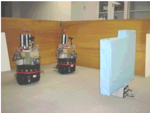
(a) 監督ロボット4, 作業ロボットマーカ点灯時 画像取り込み
