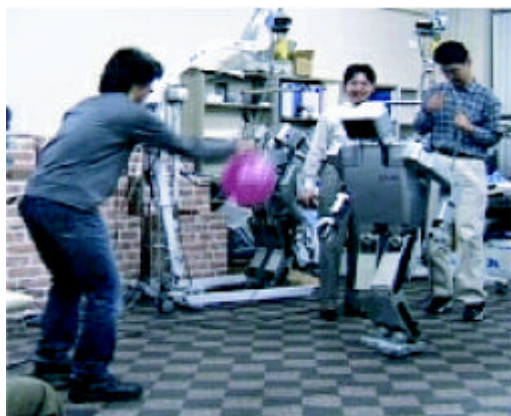
図 1: 視覚情報に基づき移動対象物を追う二足歩行オンライン制御実験
