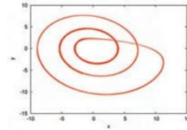
図 2: レスラー系にアルゴリズムを適用した結果. 3 周期の不安定周期軌道が検出されている. パラメータを  $a = 0.2, b = 0.2, c = 5.7$  とする.
