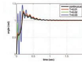
図1: ステップ応答 (連続時間ベース設計)
