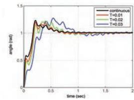
図2: ステップ応答 (デルタ領域設計)
