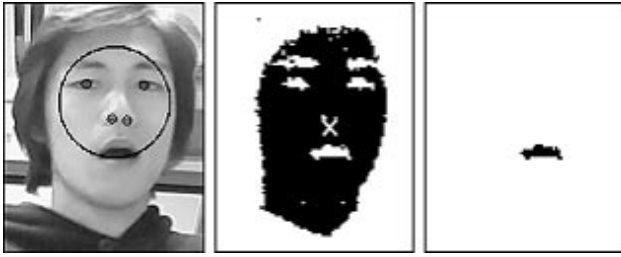
図 2. 顔認識と同時に行われる口検出。口の動きがマイクロフォンで定位された音の強弱と相関をもつかが話者特定の情報となる。
