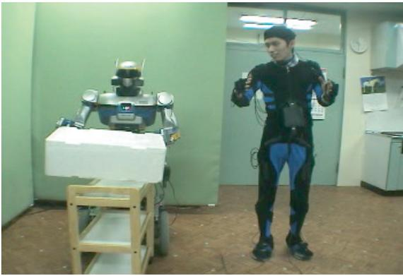
図 8: モーションキャプチャデバイスによるオンライン動作教示
