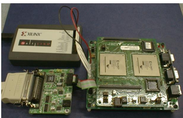
図3. 超ディペンダブルL S I開発用テストベッド
