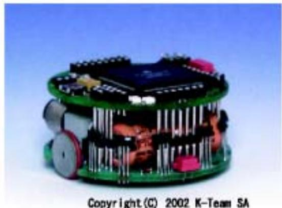
図 2 小型移動ロボット Khepera
