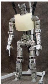
実機での実験も進めている。左図のヒューマノイドロボットは、外形、自由度構成、関節可動範囲、モータ出力などの点で全身ダイナミック行動に適した設計である。実機埋め込みの専用通信制御系を用いて、全軸  $10\text{kHz}$  以上のサーボ周期を達成し、ダイナミック行動に必要な高応答、高出力の制御を実現した。実験は、座る状態までの遷移に成功しているが、足支持期への移行には失敗している。その主原因は、床との相互作用の影響でシミュレーションとの食い違いが出ていることである。今後、改善し、起き上がり動作全体の成功を目指す。
